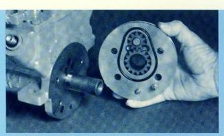
GEAR-TYPE FUEL TRANSFER PUMP
