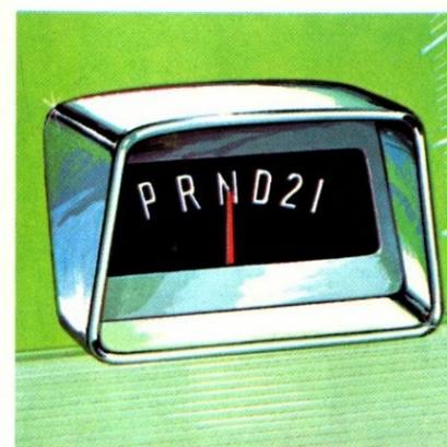
La transmission automatique de la Plymouth, avec levier de vitesses monté sur la colonne, a le cadran sélecteur incorporé au tachymètre. Sur certains modèles, les réglages automatiques sont au plancher.
