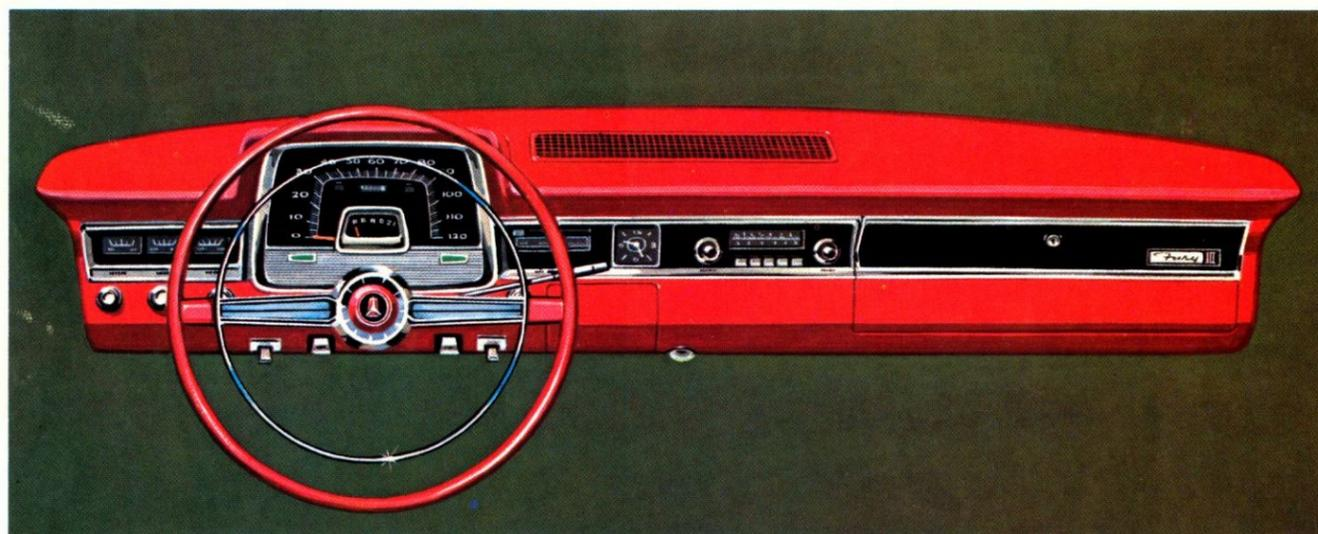
Le tableau de bord de la Plymouth groupe tous les instruments principaux directement en face du conducteur et place les autres commandes et commutateurs à sa gauche. Les réglages coulissants de la chaufferette sont à la droite du tachymètre. Tout l'aménagement offre un style d'une beauté distinctive et est en même temps fonctionnel.
