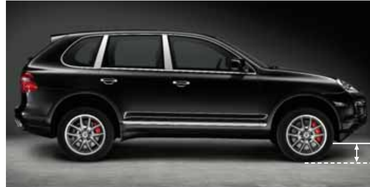
High Level II: 271 mm Cayenne GTS: 251 mm
