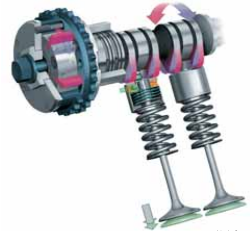
VarioCam Plus (V8 engines)
