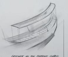
GROOVES ON THE BUMPER GLARD FIT INTO GROOVES ON THE BUMPER
