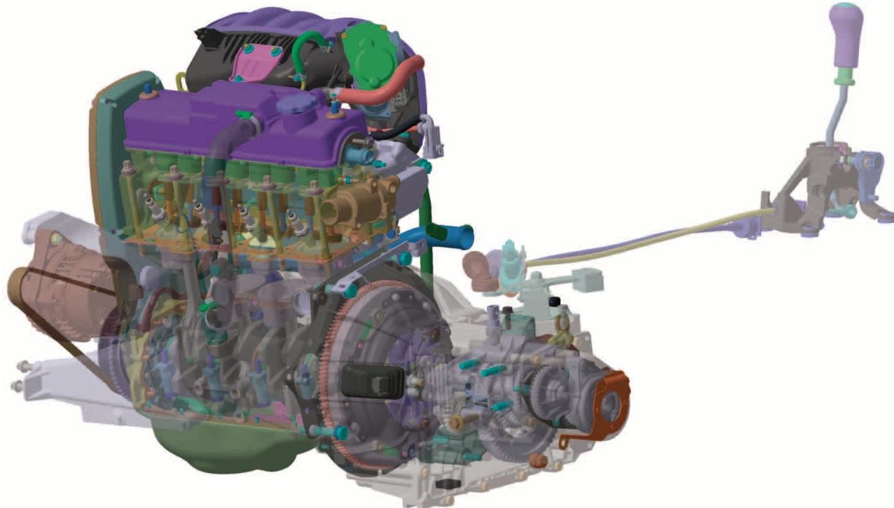
Базовым двигателем для НОВОЙ LADA Kalina стал современный, надежный и тяговитый восьмиклапанник с облегченной шатунно-поршневой группой – 11186/21116, с рабочим объемом 1,6 л., мощностью 87 л.с. Новый для LADA Kalina двигатель отличает экономичность, низкий уровень шумов и вибраций. Плюс к тому мотор более экологичный и долговечный.
