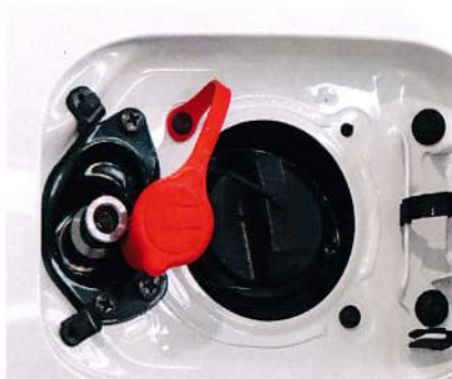
Заправочное устройство для заполнения газом расположено с правой стороны автомобиля в лючке рядом с горловиной бензобака.
