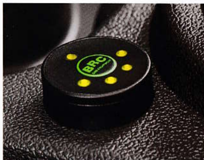
Переключатель газ/бензин расположен рядом с рукояткой переключения передач и имеет четырёхуровневое отображение количества метана в баллоне.
