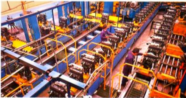
Linea de verificacion (Planta de motores Saltillo)
