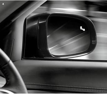
1. REVERSE PARK CAMERA WITH GUIDANCE 2. ADAPTIVE CRUISE CONTROL AND INTELLIGENT EMERGENCY BRAKE (IEB) 3. ADAPTIVE FRONT HEADLAMPS WITH INTELLIGENT HIGH BEAM 4. BLIND SPOT MONITOR
