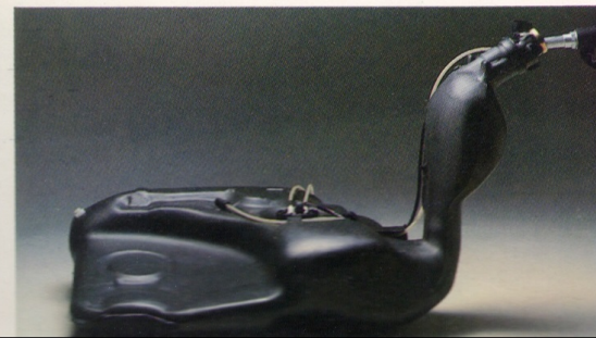
Tanque de gasolina. 55 litros.
