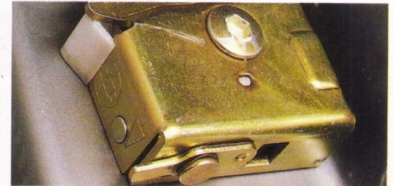
Dispositivo de seguridad en puertas traseras.- Impide a los niños abrir las puertas desde el interior, salvaguardando su integridad física.
