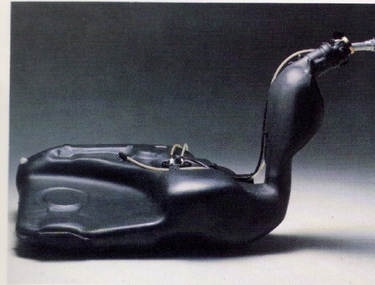
Tanque de gasolina. - Diseñado para aprovechar todo el espacio disponible, aumentando su seguridad y capacidad de almacenamiento de combustible.
