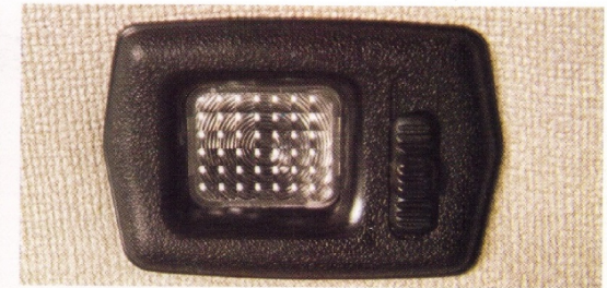
Luz de lectura.- Luz auxiliar en puerta trasera del automóvil. Valioso dispositivo que brinda mayor comodidad a los pasajeros.
