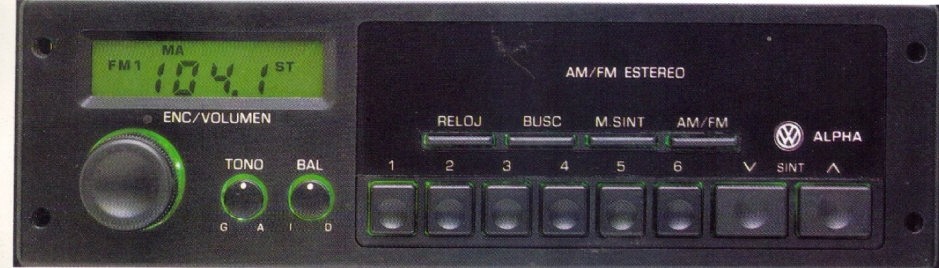
Radio AM/FM Alfa estéreo digital.- Sofisticado equipo acústico con pantalla de cristal líquido y sintonía electrónica. Cuenta con 6 memorias para AM y 12 para FM, cancelador de ruidos y reloj. (Equipo opcional).
