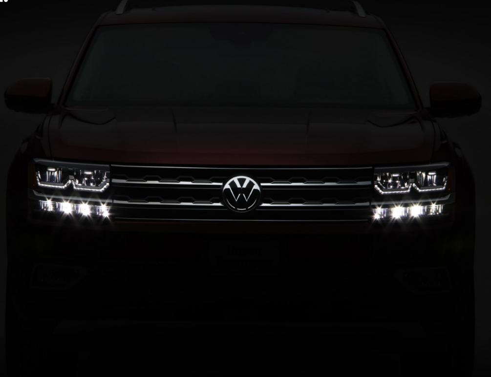
El asistente de luces con cámara multifunciones | HL permite percibir autos y transeúntes para que nada interrumpa tu camino. Además, el monitoreo de tráfico impedirá que deslumbres a otros conductores.
