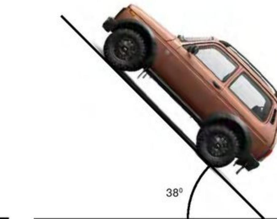
Угол преодолеваемого уклона
