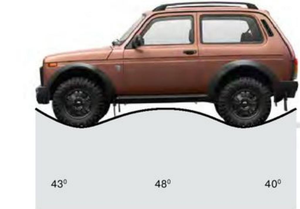
Угол въезда, угол рампы, угол съезда
