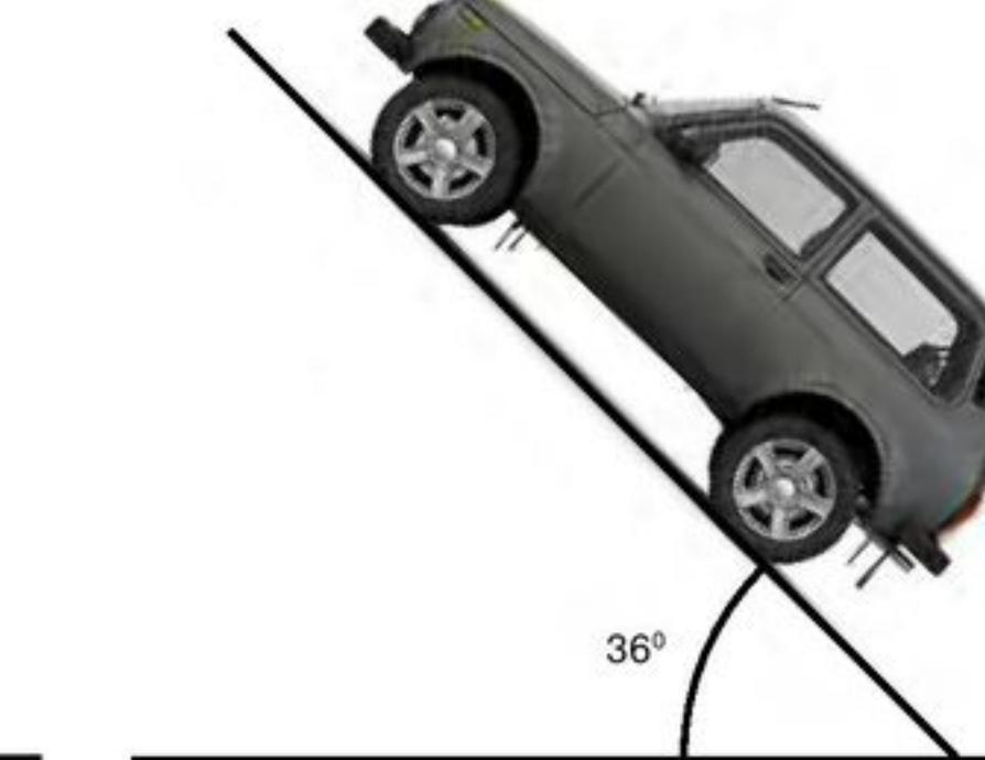
Угол преодолеваемого уклона
