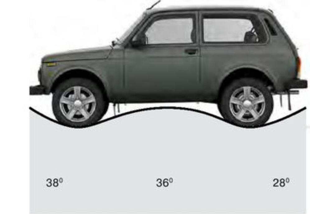
Угол въезда, угол рампы, угол съезда
