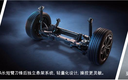
SLA长短臂刀锋后独立悬架系统，轻量化设计，操控更灵敏。
