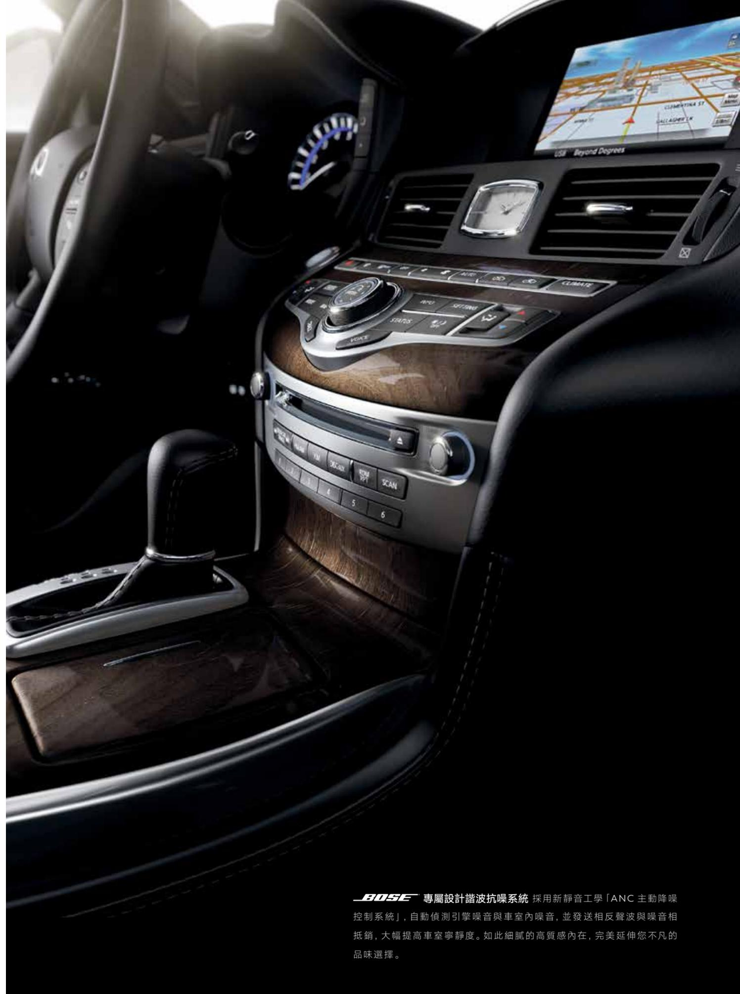
**BOSE 專屬設計諧波抗噪系統** 採用新靜音工學「ANC 主動降噪控制系統」，自動偵測引擎噪音與車室內噪音，並發送相反聲波與噪音相抵銷，大幅提高車室寧靜度。如此細膩的高質感內在，完美延伸您不凡的品味選擇。
