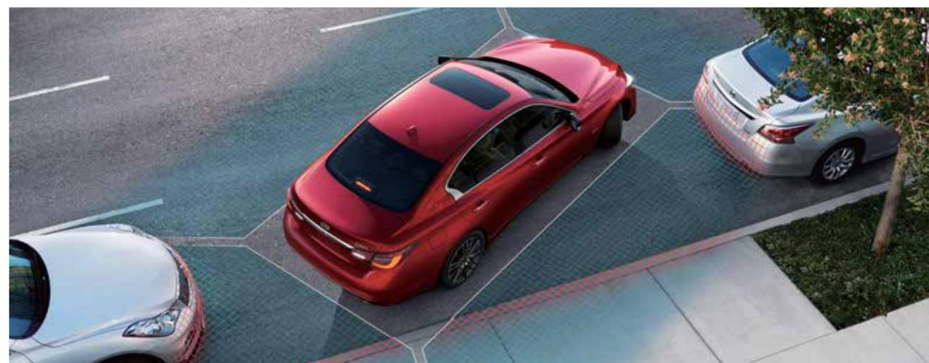
**BCI 倒車後撞預防系統** 可於倒車時主動偵測後方靜止或移動物體，消除視覺死角，並在預測到碰撞危險時主動煞車，提供最完善的安全保障。(2.5 旗艦款 / 3.7 旗艦款專屬)
