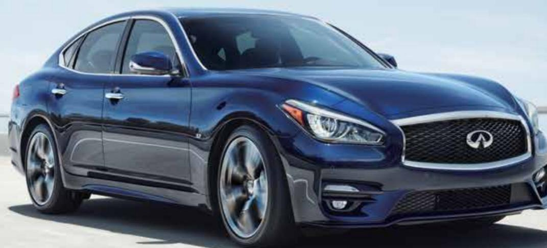
**前中置引擎後輪驅動 · 53/47 車身配重** INFINITI 採取創新的前中置 (FRONT MIDSHIP) 底盤搭配後輪驅動設定，讓 Q70 的重心，精準地落在車身中線前 3%，以 53/47 的靜態車身配重，達成完美的預備行駛狀態。當巡航展開，重心將自然前傾，以強化前輪抓地力；加速時，重心也會自然後移，確保靈敏的反應與平衡，創造更完美的動態表現。
