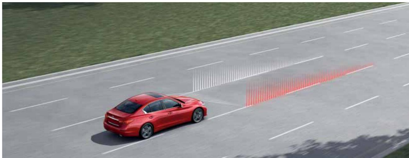
**PFCW 車輛追撞警示系統 / FEB 自動急停輔助系統** 全球首創的車輛追撞警示系統，能同時偵測前車與其前車 (前前車) 的動態。當系統偵測到前車與前前車有追撞可能時，將以警示音與燈號警告駕駛，降低事故風險；當系統發現您即將與前車發生碰撞意外時，系統將束緊安全帶，並主動緊急煞車，協助駕駛將車輛煞停，將發生碰撞的機率降至最低，提升行車安全。(2.5 旗艦款 / 3.7 旗艦款專屬)
