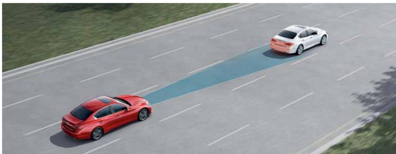
**BSI 盲點側撞預防系統** 當啟動方向燈欲變換車道時，以後保桿內兩側的遠距感應雷達偵測後方來車，並在距離過近時自動協助修正回原車道，避免危險。(2.5 旗艦款 / 3.7 旗艦款專屬)
