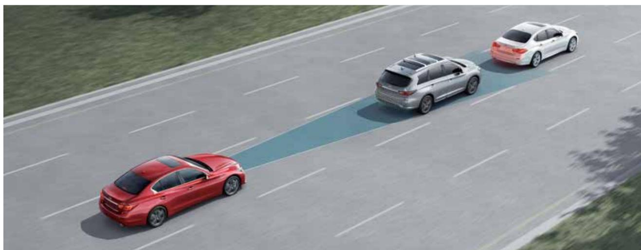
**ICC 全速域智慧定速系統 / DCA 車距控制輔助系統** 當車速介於 0 至 144km/h 時，您可依偏好設定遠、中、近三種車距，ICC 將配合前車的速度變化自動加速、減速，達到自動跟車的效果；當車速高於 5km/h 以上時，DCA 會持續監控您與前車是否保持足夠的安全距離，若系統判定您與前車距離過近時，將自動頂起油門，並輕踩煞車減速，預防煞車不及的狀況發生，讓您在擁擠的市區能更加地安心駕駛。(2.5 旗艦款 / 3.7 旗艦款專屬)
