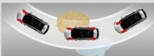
ESP 電子車身動態穩定系統 / VSM 整合式車身動態管理系统 (附自動轉向修正)
