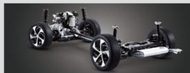
智慧可變四輪驅動系統/平整化底盤
