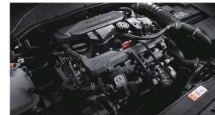
/ 全新Hyundai SmartStream 渦輪增壓引擎 CVVD連續可變汽門持續系統
