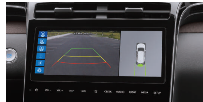
SVM 環景影像輔助系統 透過車身周圍四個廣角鏡頭，清晰捕捉每個角度，提供全面視野，幫助駕駛停車更加安全順利。
