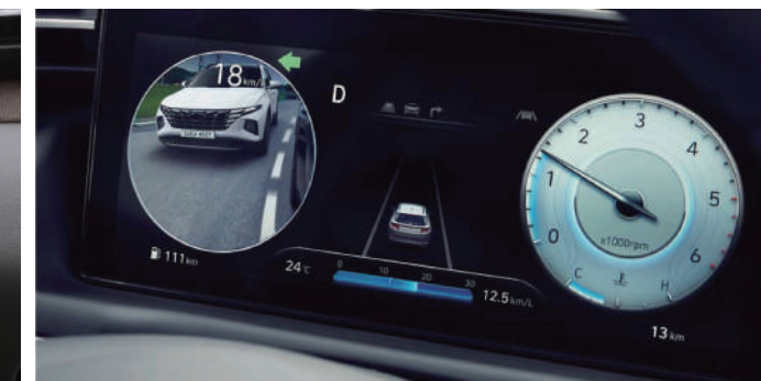
BVM 盲區影像輔助系統 當想要切換車道撥下方向燈時，後視鏡頭就會啟動，盲區影像將會清楚地顯示在數位儀表板上。
