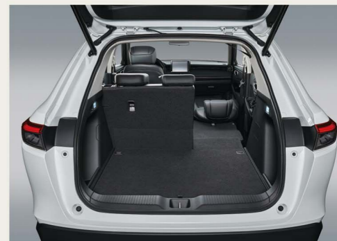
Long Mode 超長 L 模式 將助手席前座椅背後倒 同時讓後座椅向前打平，即可放置尺寸超長物品
