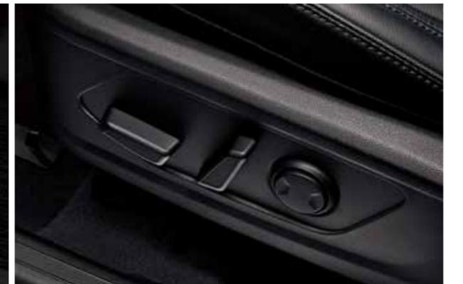
駕駛座 10 向電動調整座椅 (附 2 向腰靠調整)
