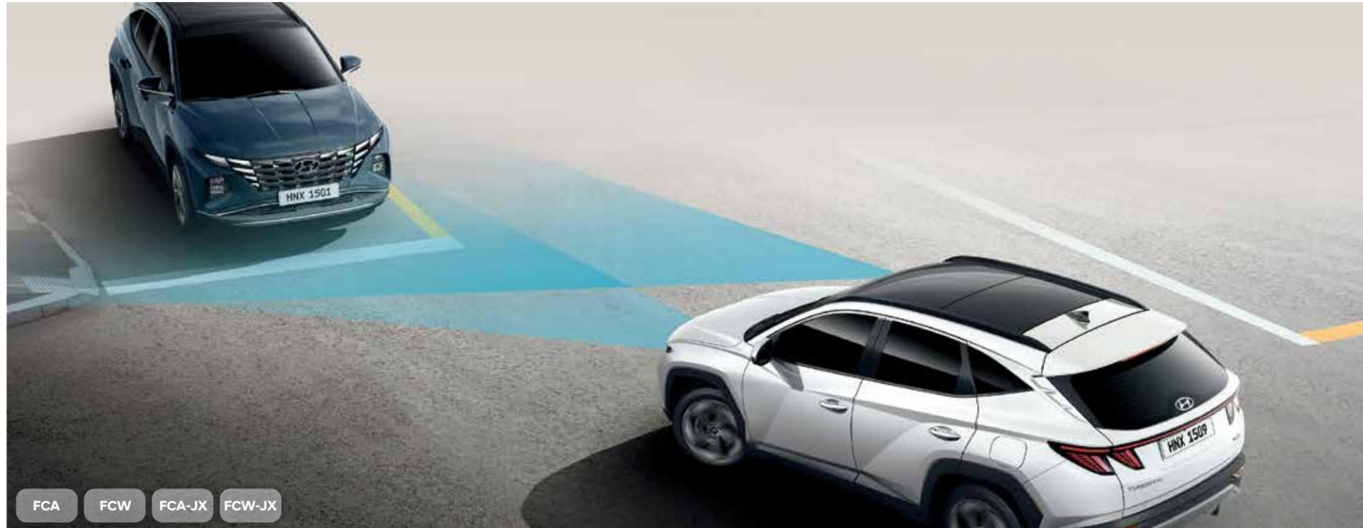
FCA 前方主動煞停輔助系統 (含汽車 / 行人 / 騎士) / FCW 前方撞擊警示系統 / FCA-JX 對向來車路口煞停輔助系統 / FCW-JX 對向來車路口安全偵測系統
