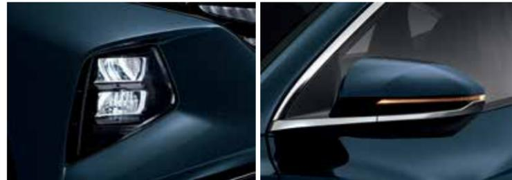
LED 分離式頭燈 (附轉向輔助照明)    LED 後視鏡方向燈
