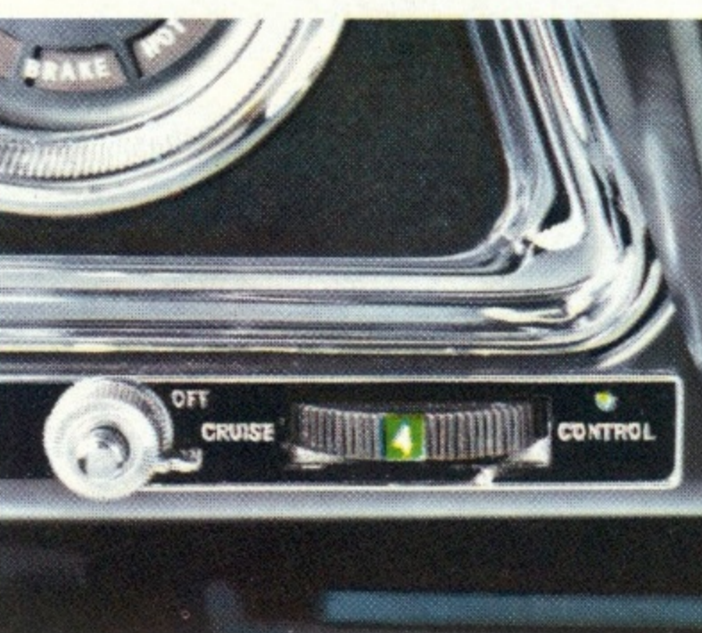
Commande automatique Cruise Control. Maintient une vitesse prédéterminée. La résistance de la pédale à la pression du pied augmente pour indiquer que la vitesse choisie est atteinte. Livrable dans tous les modèles sauf dans les F-85.
