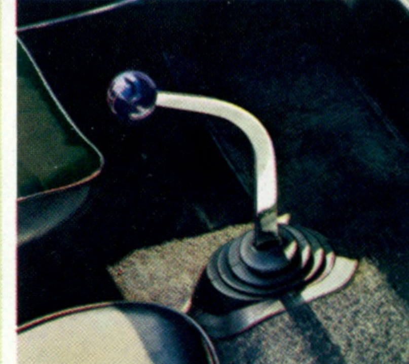
Boîte à 4 rapports avec levier au plancher. Rapports rapprochés, tous synchronisés; moyennant supplément. Livrables dans les modèles importés sauf la Quatre-vingt-dix-huit.
