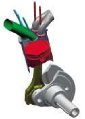
Condotti lucidati per una migliore fluidodinamica Polished inlet ports for improved fluid dynamics
