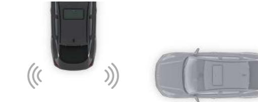
Система предупреждения о поперечном столкновении при движении задним ходом (RCTA\*) предупредит об опасности при движении задним ходом в условиях ограниченной видимости.
