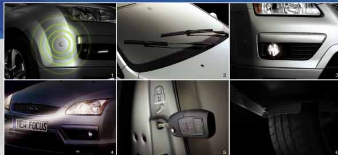
1. 雙鞋車導引前雷達 2. 無支架翼式雨刷 3. 晶圓球體投射式前霧燈 4. Follow me home 跟燈安全照明功能 5. 後座兒童安全鎖 6. 車底導流板 (含前/後輪)
