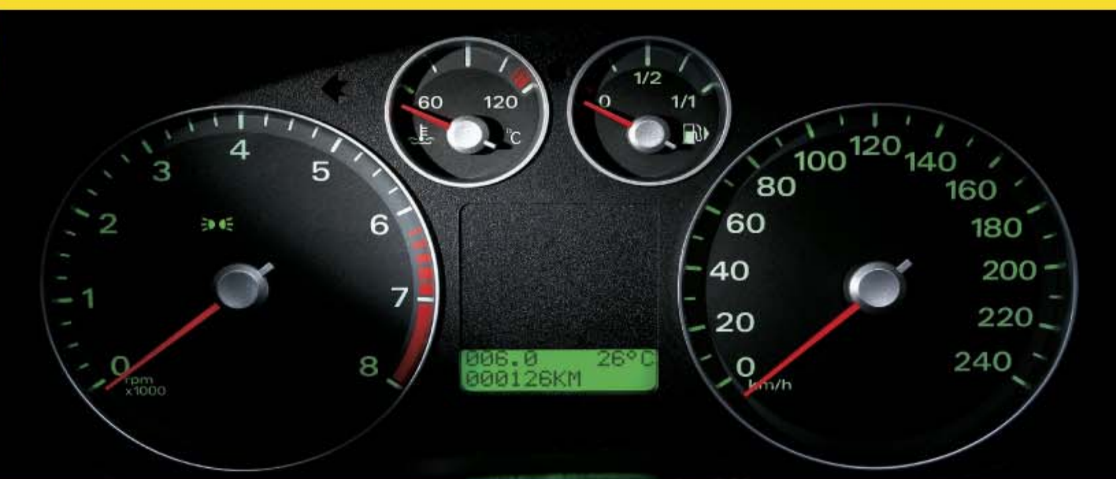
跑车式镀铬四环仪表和旅程电脑 以熏黑色为主体的四环式镀铬仪表设计,不但外形简洁流畅,更大幅提高辨识度。旅程电脑随时提供车速、剩余油量、可行驶里程与车外温度等,让驾驶者精确掌握相关信息。
