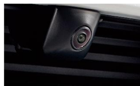
带清洗功能的180度前视摄像头 180度前视摄像头为驾驶员提供可视面积约180度的影像,以便驾驶员更好地了解车前区域的状况。
