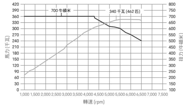
Cayenne E-Hybrid：340 千瓦 (462 匹)/引擎轉速於 5,250 至 6,400 rpm 之間；700 牛頓米/引擎轉速於 1,000 至 3,750 rpm 之間
