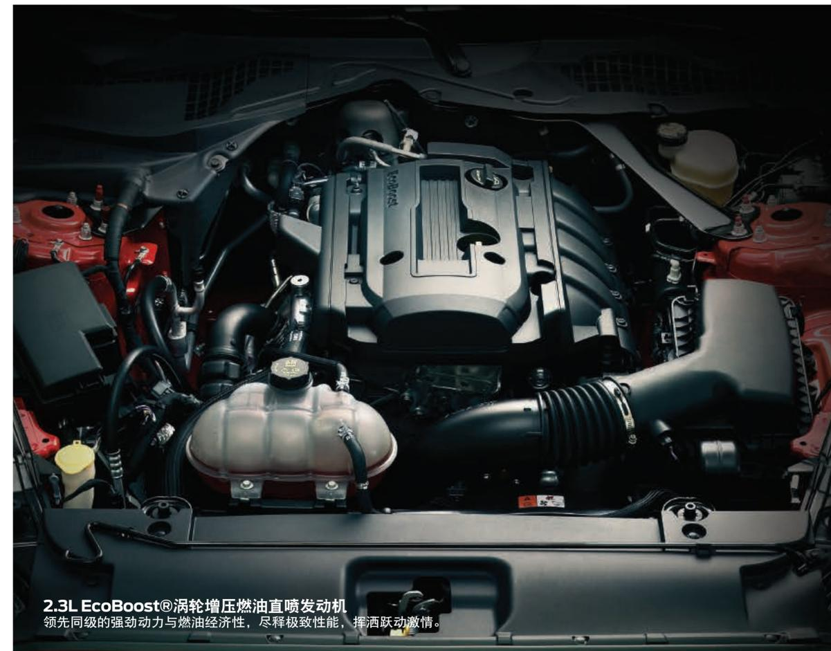
**2.3L EcoBoost®涡轮增压燃油直喷发动机**
