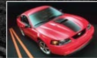
MUSTANG Mach 1 車型回歸。它搭載 305ps V8 引擎和經典的「Shaker」式引擎蓋進氣口。
