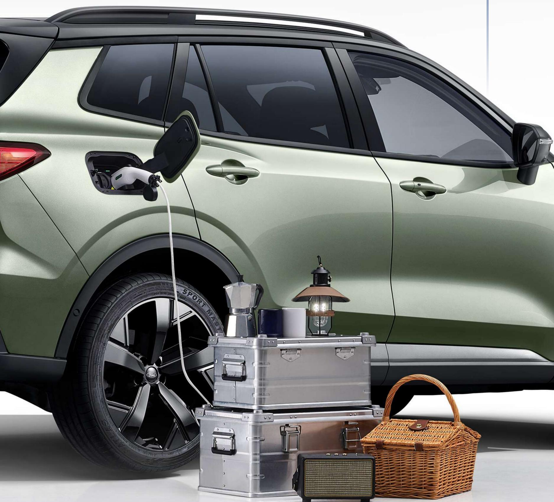
\* 领睿插电混动SUV对外放电功率为3.3kW，电压为220V。
