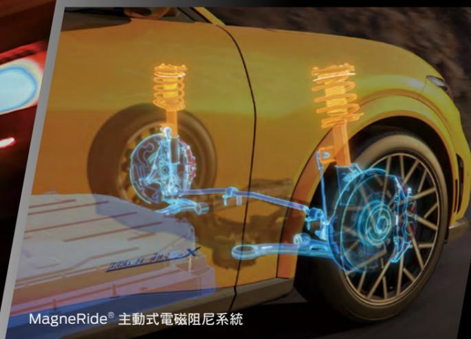
MagneRide® 主動式電磁阻尼系統
