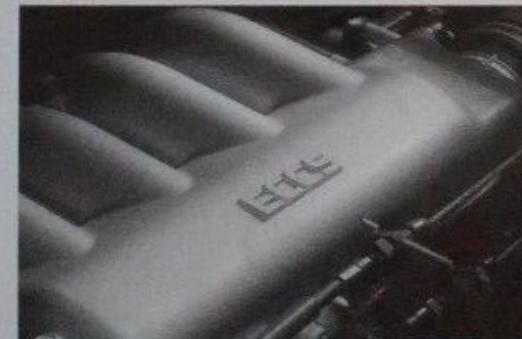
Grâce au dispositif de distribution variable, à l'injection de carburant sequentiel multiple et au système de gestion électronique de Nissan, le moteur de 1,6 litre du coupé Sentra équilibre
